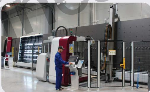
La nuova fabbrica ADF, con una superficie di 6500 mq, ospita attrezzature automatizzate all'avanguardia, che eseguono in modo completamente automatico i pacchetti di vetrocamera destinati alla realizzazione dell'infisso.
